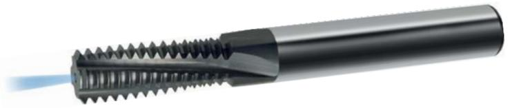
Fresa a filettare in metallo duro integrale rivestita TiCN, scanalature elicoidali destre, **per filettatura destra e sinistra** ISO metrica, attacco cilindrico DIN 6535, con foro assiale di lubrificazione, **2xD**, per fori **passanti e ciechi**. Per lavorazioni di acciai legati e non, ghise, leghe di alluminio e materiali non ferrosi.
