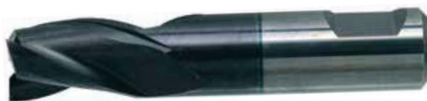
Fresa codolo cilindrico weldon DIN 6535-HB in metallo duro integrale con rivestimento multistrato ENERGY a 3 taglianti, tagliente al centro, elica 30°, spoglia 12°, per esecuzione sedi di chiavette e asole. **Per lavorazioni di acciai legati e non, ghise e leghe di alluminio.**
