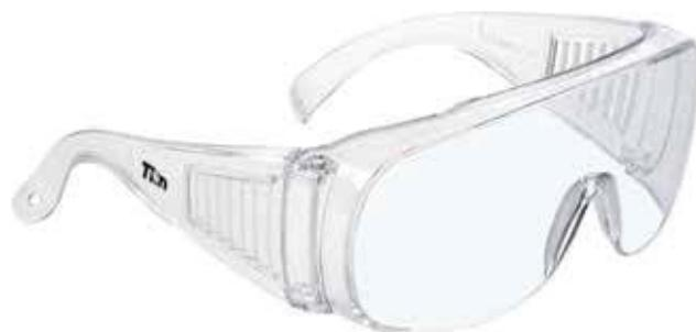
Occhiali di protezione a mascherina in policarbonato trasparente controllata otticamente, lente neutra UC, montatura neutra con sistema di areazione ricavato nelle protezioni laterali, sovrapponibile ai comuni occhiali da vista, per uso generico e per visitatore. Conforme alla norma **EN 166 EN 170 (2-1,2 U 1 F CE)**.
