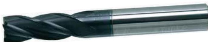
Fresa codolo cilindrico DIN 6535-HA in metallo duro integrale con rivestimento multistrato ENERGY a 4 taglienti, **tagliente lungo 2xD**, elica 30°, spoglia 9°, per esecuzione in contornatura. **Per lavorazioni di acciai legati e non e ghise.**
