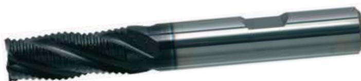
Fresa codolo cilindrico weldon DIN 6535-HB in metallo duro integrale con rivestimento multistrato ENERGY a 4 taglienti, elica 30°, spoglia 9°, per sgrossatura e contornatura. **Per lavorazioni di acciai legati e non, acciai temprati e acciai inox.**
