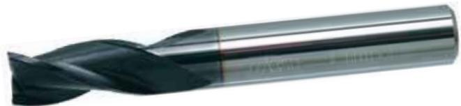
Fresa codolo cilindrico DIN 6535-HA in metallo duro integrale con rivestimento multistrato ENERGY a 3 taglienti, **tagliente lungo 1,5xD**, elica 30°, spoglia 9°, per esecuzione sedi di chiavette e asole. **Per lavorazioni di acciai legati e non e ghise.**
