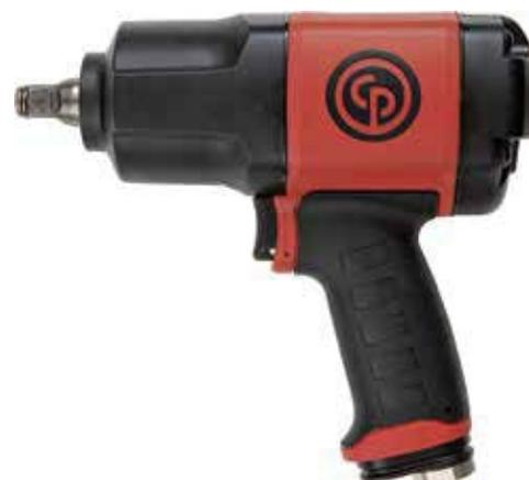
Avvitatore pneumatico antiurto ad impulso da 1/2", **corpo in materiale composito**, con isolamento in gomma termoplastica iniettata in alloggiamento per una presa resistente e confortevole, frizione con doppia massa battente, reversibilità con singola mano, tubo consigliato ø 10 mm.
