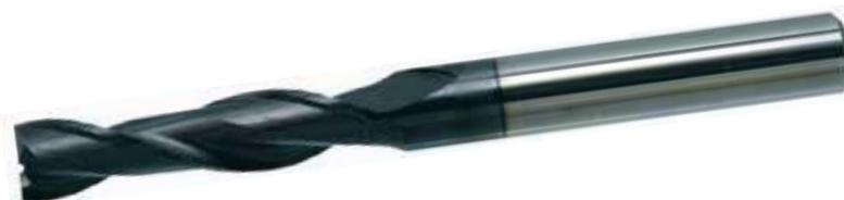
Fresa codolo cilindrico DIN 6535-HA in metallo duro integrale con rivestimento multistrato ENERGY a 2 taglienti, **tagliente extralungo 3xD**, elica 30°, spoglia 9°, per fresatura in profondità. **Per lavorazioni di acciai legati e non e ghise.**
