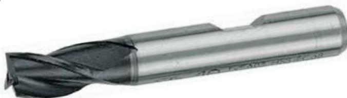
Fresa codolo cilindrico weldon DIN 1835-B a 3 taglienti per cave, in acciaio HSS Co8 rivestita TiAIN, **serie corta**, elica 30°, angolo di spoglia 12°, tagliente al centro. Per esecuzione sedi chiavette e scanalature.
