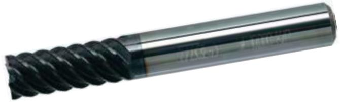
Fresa codolo cilindrico DIN 6535-HA in metallo duro integrale con rivestimento multistrato ENERGY a 6/8 taglienti, elica 55°, **spoglia negativa -5/-10°**, per esecuzione di superfinitura in contornatura, adatta per lavorazioni ad alte velocità.
