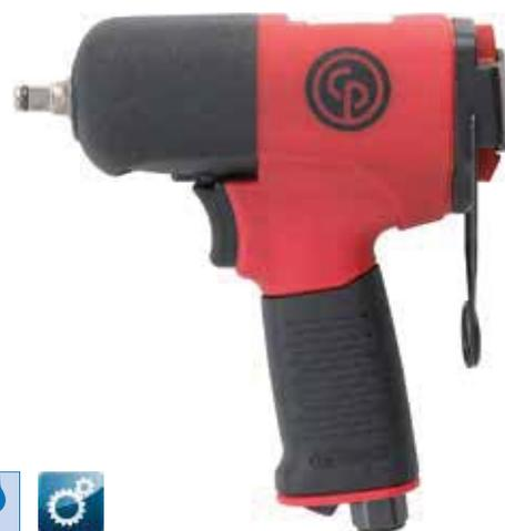
Avvitatore pneumatico ad impulso da 3/8", **corpo in materiale composito e alloggiamento massa in alluminio**, massa a doppio martello, 3 impostazioni di potenza in avanzamento e potenza piena in svitatura, impugnatura morbida ed ergonomica soft-grip, trattenimento bussola ad anello.
