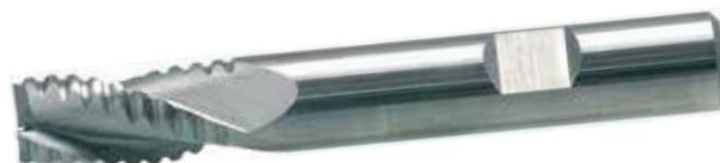
Fresa codolo cilindrico Weldon DIN 6535-HB in metallo duro integrale a 3 taglienti, elica 30°, per **grossatura ad alto rendimento**. **Per lavorazioni di leghe di alluminio e materiali non ferrosi.**
