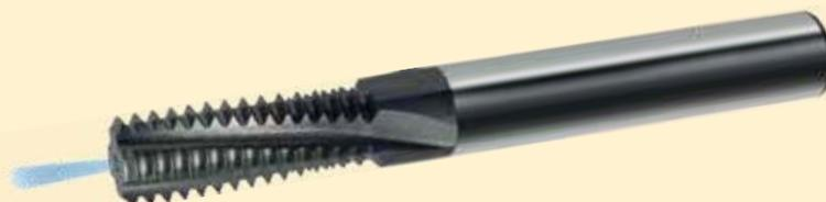
**Fresa a filettare** in metallo duro integrale rivestita TiCN, scanalature elicoidali destre, **per filettatura destra e sinistra** ISO metrica, attacco cilindrico DIN 6535, con foro assiale di lubrorefrigerazione, **2xD**, **per fori passanti e ciechi. Per lavorazioni di acciai legati e non, ghise, leghe di alluminio e materiali non ferrosi.**
