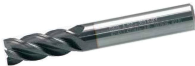
Fresa codolo cilindrico DIN 6535-HA in metallo duro integrale con rivestimento multistrato ENERGY a 4 taglienti, tagliente al centro, **elica con passo differenziato 40/42°** per permettere una maggiore stabilità con una velocità di avanzamento superiore fino a ca. il 60% rispetto alle frese tradizionali, diminuisce l'usura dell'utensile, annulla le vibrazioni e permette una maggiore profondità di taglio. Per finitura. **Per lavorazioni di acciai legati e non e acciai inox.**
