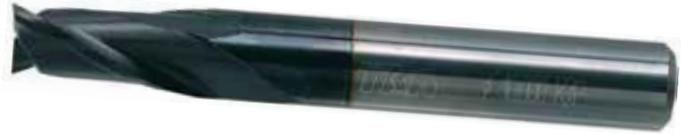
Fresa codolo cilindrico DIN 6535-HA in metallo duro integrale con rivestimento multistrato ENERGY a 2 taglienti, **tagliente lungo 1,5xD**, elica 30°, spoglia 9°, per esecuzione sedi di chiavette e asole. **Per lavorazioni di acciai legati e non e ghise.**
