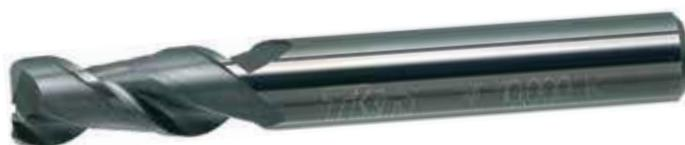
Fresa codolo cilindrico DIN 6535-HA in metallo duro integrale a 2 taglienti, per alluminio, elica 45°, spoglia 25°, per eseguire operazioni di semi-finitura e finitura ad alta velocità. **Per lavorazioni di leghe di alluminio e materiali non ferrosi.**
