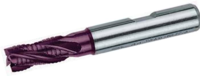
Fresa codolo cilindrico weldon DIN 1835-B a 4 taglienti, in acciaio HSS Co8 rivestita TiAlN, **serie corta a semifinire**, elica 30°, angolo di spoglia 12°, tagliente al centro a profilo piatto rettificato. **Per lavorazioni di acciai legati e non e ghise.**
