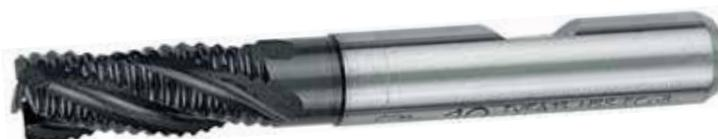
Fresa codolo cilindrico weldon DIN 1835-B a 4 taglianti, in acciaio HSS Co5 rivestita TiAlN, serie corta per sgrossatura, elica 30°, angolo di spoglia 14°. **Per lavorazioni di acciai legati e non e ghise.**
