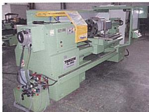
l'operatore è in grado sia di eseguire torniture tradizionali con quote visualizzate e avanzamenti con selezione continua sia di realizzare pezzi complessi seguendo la programmazione guidata.
