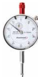
Cassa in metallo, quadrante girevole con vite di bloccaggio e contagiri, indicatori di tolleranza regolabili, punta tastatore sostituibile M 2,5 mm, precisione secondo norma DIN 878. Campo di misura: 0÷10 mm. Risoluzione: 0,01 mm. Ø stelo h6: 8 mm.
