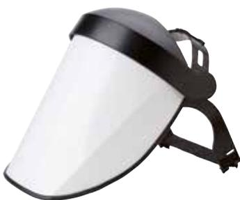
In policarbonato trasparente. Per i lavori in cui il volto va protetto da schizzi di sostanze chimiche o da particelle volatili. Supporto regolabile a banda elastica. Certificata per impatti a media energia fino a 120 m/s. Conforme alla norma EN 166.
