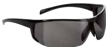
Mod. Polaris lente grigia in policarbonato, antigraffio e antiappannamento, protezione contro l'abbagliamento e UV400, montatura di colore nero, astine avvolgenti antiscivolo, in materiale bicomponente. Conforme alla norma EN 166, EN 172.
