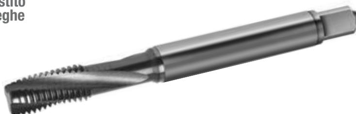
Maschio a macchina in acciaio HSS-E PM rivestito TiCN, passo grosso, **DIN 371 M3-10 con gambo rinforzato, DIN 376 M12-M16 con gambo passante**, forma C imbocco 2-3 filetti, scanalature elicoidali destre a 15°, filetti rettificati e spogliati, **per fori ciechi**. Per filettatura metrica ISO e DIN 13. **Per lavorazioni di titanio e leghe di titanio.**
