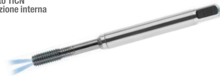
Maschio a macchina **a rullare** in acciaio HSS-E PM rivestito TiCN, passo grosso, **tolleranza ISO 2 / 6HX, DIN 371 M3-10 con gambo rinforzato, DIN 376 M12 con gambo passante**, codolo con **tolleranza h6** può essere utilizzato in tutti i mandrini, forma C imbocco 2-3 filetti, **con lubrificazione interna, per fori passanti e ciechi**, la geometria poligonale permette di ottimizzare la superficie di contatto.
