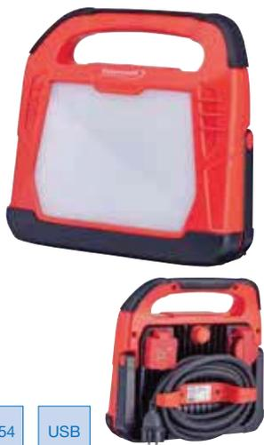
Faretto a LED, corpo in alluminio pressofuso rinforzato con vetro di sicurezza, luminosità regolabile in continuo (0-100%), LED di marca di alta qualità per illuminazione senza abbagliamento di grandi dimensioni, angolo del fascio di 120°. Custodia pieghevole realizzata in plastica di alta qualità con telaio parzialmente gommato, 2 magneti potenti nel telaio per l'attacco a superfici metalliche. Porta USB e presa con messa a terra sul retro. Temperatura di esercizio da -20 °C a +50 °C.
