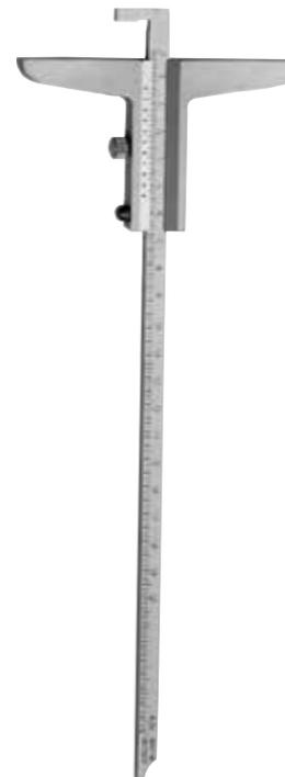
Calibro a corsoio di profondità con gradino, in acciaio inossidabile temprato, asta di misurazione sfalsata, nonio cromato opaco e inciso su entrambi i lati con graduazione bilaterale della guida di misurazione, precisione secondo norma DIN 862. Utilizzabile anche come normale calibro di profondità con vite di bloccaggio.
