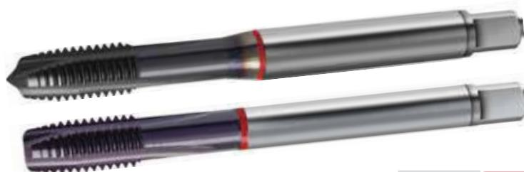
Maschio a macchina in acciaio HSS-E rivestito TiCN, passo grosso, **anello rosso, DIN 371 M3-10 con gambo rinforzato, DIN 376 M12-M16 con gambo passante**, forma B imbocco corretto 4-5 filetti, filetti rettificati e spogliati, **per fori passanti**. Per filettatura metrica ISO e DIN 13. **Per lavorazioni di acciai da costruzione, da bonifica e da cementazione legati e non, acciai da utensili e super rapidi.**
