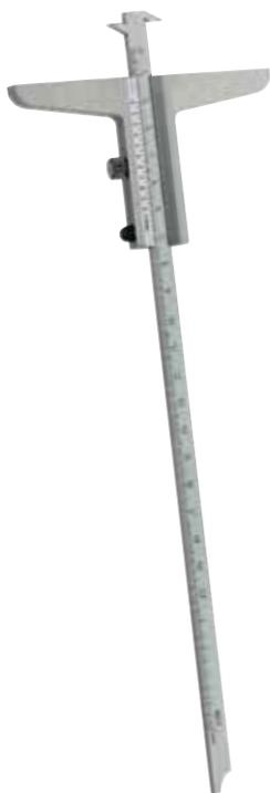
Calibro a corsoio di profondità con doppio gancio, in acciaio inossidabile temprato, asta di misurazione sfalsata bilaterale, nonio cromato opaco e inciso su entrambi i lati con guida di misurazione, bloccaggio a vite, precisione secondo norma DIN 862.
