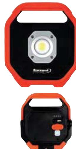
Faretto a LED, con batteria 10 W, corpo in alluminio stampato ad iniezione con maniglia di trasporto integrata e base regolabile, luminosità regolabile su 2 livelli (30-100%), batteria con indicatore del livello di carica e uscita USB, quindi è possibile utilizzarla anche come power bank, fornito con cavo di ricarica e caricabatterie. Tipo batteria Li-Ion-Akku 3,7 V / 4400 mAh.
