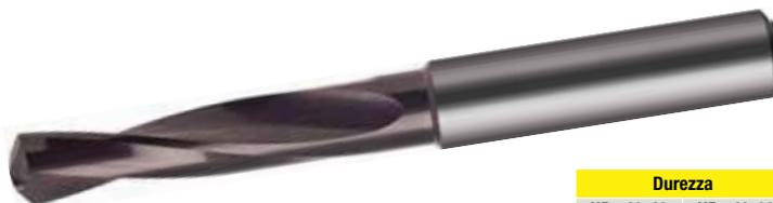
Punta codolo cilindrico in metallo duro integrale, rettificata, rivestita A-TiAl, assottigliamento del nocciolo  $\geq \varnothing 2,6$  mm, affilatura su piani, tagliente principale di forma dritta, i taglienti convessi assicurano una stabilità elevata con un controllo del truciolo ottimale. Per eseguire forature fino a 3xD.
