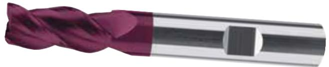
Fresa codolo cilindrico DIN 6535-HB in metallo duro integrale con rivestimento TiAlN, a 3 taglienti con angolo evolvente variabile 35/38°, la spaziatura dei taglienti e la particolare spoglia permettono lavorazioni di sgrossatura e finitura con basse vibrazioni, elevata silenziosità, taglio centrale, angolo di raccordo 45°, concentricità <0,01 mm. **Per lavorazioni di acciai inox e leghe di titanio.**
