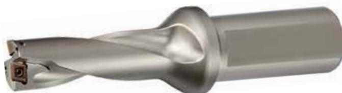
Punta ad inserti codolo cilindrico DIN 1835 E con passaggio interno del lubrorefrigerante, per fori fino a 5x D tolleranza foro  $\pm 0,20\text{mm}$ .
