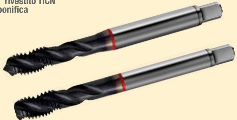
Maschio a macchina in acciaio HSS-E rivestito TiCN, passo grosso, **anello rosso, DIN 371 M3-10 con gambo rinforzato, DIN 376 M12-M16 con gambo passante**, forma C imbocco 2-3 filetti, scanalature elicoidali destre a forte torsione a 40°, filetti rettificati e spogliati, **per fori ciechi**. Per filettatura metrica ISO e DIN 13. **Per lavorazioni di acciai da costruzione, da bonifica e da cementazione legati e non, acciai da utensili e super rapidi.**
