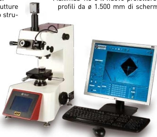
che lo rende il più grande al mondo. È particolarmente adatto per l'industria aeronautica e per quei lavori che richiedono alta precisione nella misurazione dei particolari. Isoscan è invece il nuovo microdurometro per la misurazione di microdurezze secondo le norme ISO ed ASTM con la possibilità di generazione e misurazione automatica delle impronte.
