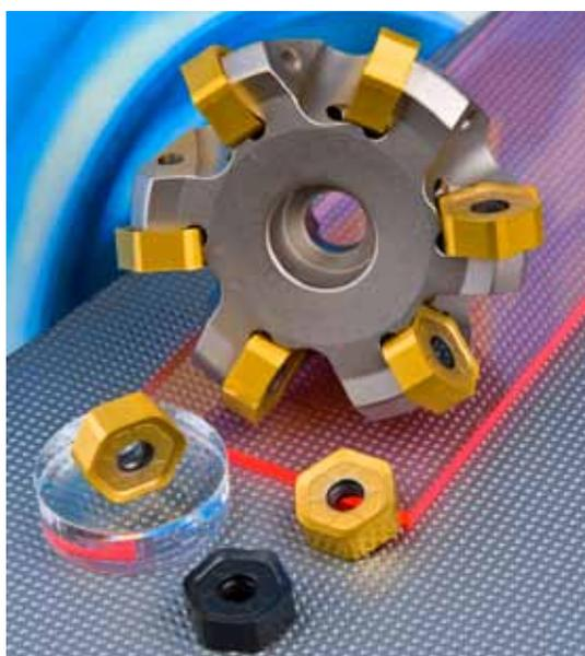
L'angolo di registrazione di queste frese è di 45°, montano inserti HNGX09 con 12 taglienti. Usando queste frese il cliente avrà la possibilità di eseguire operazioni di spianatura ad alta produttività e basso costo. Queste nuove frese possono essere impiegate per spianatura, cave o smussi. Sono anche possibili lavorazioni in rampa e a tuffo progressivo.
