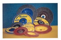
Tra l'ampia gamma di dischi lamellari di diametro 115/180 mm. prodotti da Norton, il disco R822 all'ossido di zirconio è quello più adatto per l'asportazione dei cordoni di saldatura e per la smerigliatura e pulitura di tutti gli acciai, specialmente gli inossidabili. Ciò grazie sia all'eccellente azione di taglio che è in grado di offrire, sia alla bassa rumorosità d'utilizzo e alla buona flessibilità, che permette finiture uniformi.
