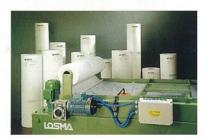
Grazie alla ricerca Losma, è da oggi possibile garantire una adeguata filtrazione dei lubrorefrigeranti impiegati nelle lavorazioni meccaniche. Losma ha infatti risolto questo problema realizzando un'apparecchiatura in grado di depurare questi liquidi, utilizzando uno speciale filtro di tessuto non tessuto che riesce a sepa-
