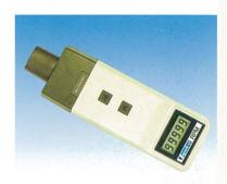
Adatto per il rilevamento di bassissime velocità (a partire da 4 giri/min.), il nuovo tachimetro elettronico portatile Microtach 8400 ha incorporato un cronometro industriale ed un circuito elettronico che consente di ottenere fino a 99,999 giri/min. e una lettura di grandissima precisione.
