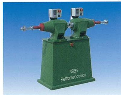
L'ultima novità delle macchine **Nebes** è questa pulitrice dalle eccezionali caratteristiche. È dotata di due motori indipendenti entrambi da 3000 Watt di potenza.
