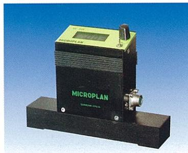
Strumento di alta precisione per il rilevamento di inclinazione e pendenze rispetto all'orizzonte o ad un angolo preso come riferimento, la livella elettronica Microplan esprime direttamente la lettura in secondi di arco mediante display numerico in cristalli liquidi.
