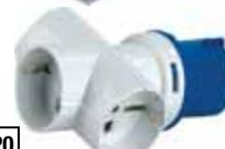
**Adattatori industriali IEC 309 16A 6h** a bassa tensione **da spina a multipresa** con 3 prese, per usi temporanei, riferimento orario polo di terra: 6h, conformi alle norme **CEI EN 60309-1** e **EN 60309-2**, grado di protezione IP44, grado di protezione contro gli impatti: IK08.
