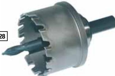
**A30722 - Caratteristiche:** con molla di espulsione, da utilizzare su pezzi piani e superfici curve, di acciaio legato e non, ghise, alluminio e sue leghe, materiali non ferrosi con spessore fino a 10 mm, (si consiglia oltre allo spessore 6 mm lo scarico dei trucioli) acciaio inox con spessore fino a 4 mm.
