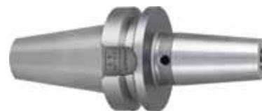
Mandrino a calettamento termico BT 40 DIN ISO 7388-2 (ex JIS B 6339 MAS BT 40) **"con superficie di contatto"** (supporto aggiuntivo sulla superficie della flangia per una maggiore rigidità) **forma AD**, per il serraggio di utensili in HSS e Metallo Duro con **codolo cilindrico in tolleranza h6**; possibilità di regolare la sporgenza dell'utensile mediante vite integrata al mandrino a partire da  $\varnothing D1 = 6$  mm. Disponibile in versione corta, ZG e extralunga.
