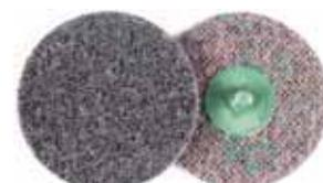
Disco abrasivo **SC-DR - Sistema Roloc™** in ossido di alluminio, su struttura in tessuto non tessuto per ridurre l'ostruzione durante la lavorazione, diverse grane per la preparazione progressiva delle superfici, dalla sbavatura alla finitura. La **grana extra fine è in carburo di silicio** per una miglior finitura prima della verniciatura o della saldatura. Ideale per la rimozione di residui di sigillanti e adesivi epossidici. Compatibile con altri sistemi presenti sul mercato.
