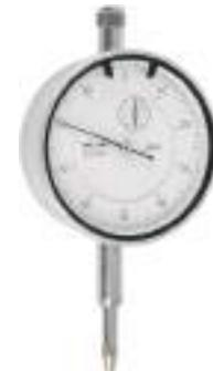
Modello di precisione, cassa in metallo, quadrante girevole con vite di bloccaggio e contagiri, indicatori di tolleranza regolabili, punta tastatore sostituibile M 2,5 mm.
